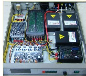
그림. 4 이온빔 발생용 다채널 고전압 전원장치 (상)와 그 내부 구성(하)
