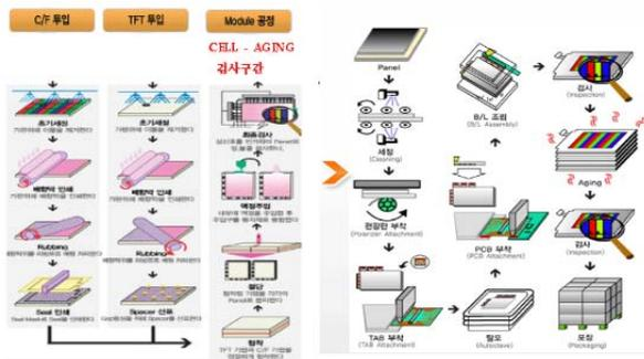
그림 4. TFT-LCD Cell Module 공정 라인
