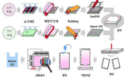
그림 2. TFT-LCD 제조 공정
