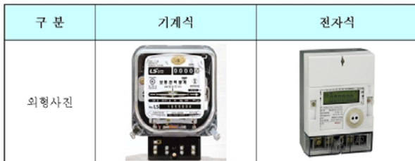
그림 2. 기계식 계량기와 전자식 계량기 Fig. 2 Mechanical meters with electronic meters
