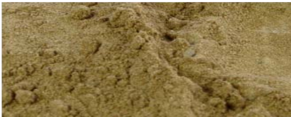
그림 4. 시험 전 시료(H1) 중량 1500g
