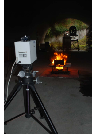
그림 2. OP-FTIR을 사용한 원격 측정실험
