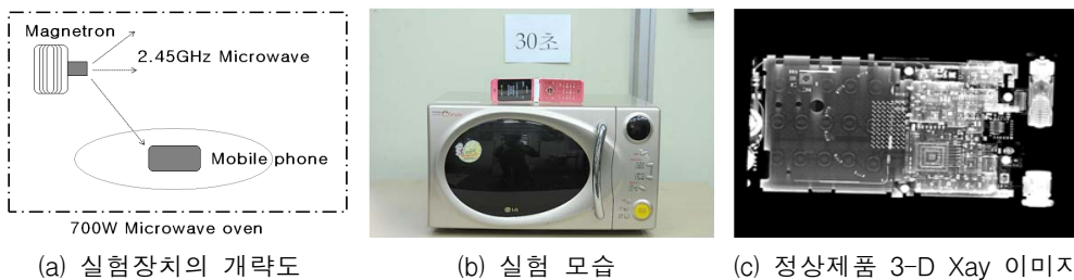
그림 2. 실험장치의 개략도 및 정상제품에 대한 3-D Xay 이미지
