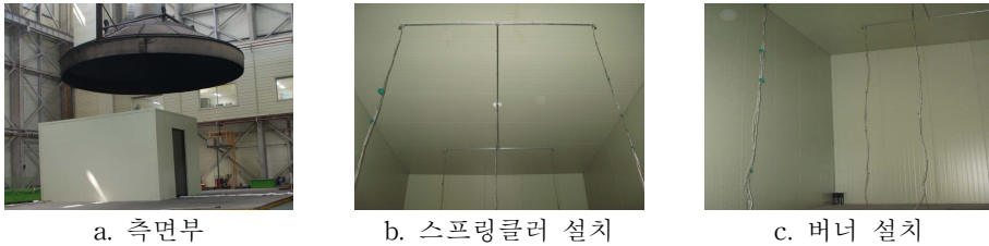
그림 1. 샌드위치패널 Mock-up 사진
