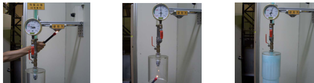
(a) 감지기작동 (b) 스프링클러작동 (c) 소화수방출 그림7. 작동실험(화재시)
