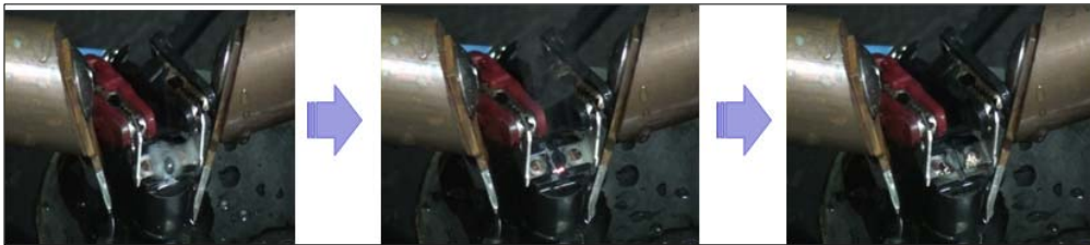
(a) 5방울째 (b) 46방울째 (c) 트래킹으로 인한 절연과괴 모습 그림 4. 트래킹 발생 실험 모습(락스 : 염소계표백제에 의한 1ms/cm 전도도 실험 모습)
