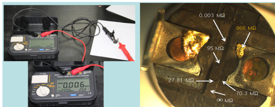
그림 5. 트래킹에 의한 절연 과괴된 발생된 서모스탯 절연저항 측정 모습 및 측정 값
