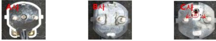
그림 6. 단상 2선식 결선에 따른 트래킹 후 사진
