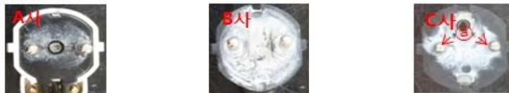
그림 5. 단상 3선식 결선에 따른 트래킹 후 사진
