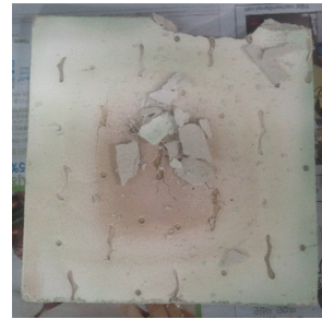
그림 2. 텍스(석고 시멘트판)의 온도에 따른 열전도율 사진 2. 열전도율 시험 후 텍스 \lambda = 0.0048 + 2.88 \times 10^{-4} T + 1.35 \times 10^{-7} T^2 \dots\dots\dots 식 2. R^2 = 0.9677
