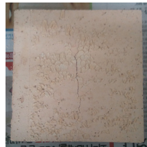
그림 1. 방화석고보드의 온도에 따른 열전도율 사진 1. 열전도율 시험 후 방화석고보드
