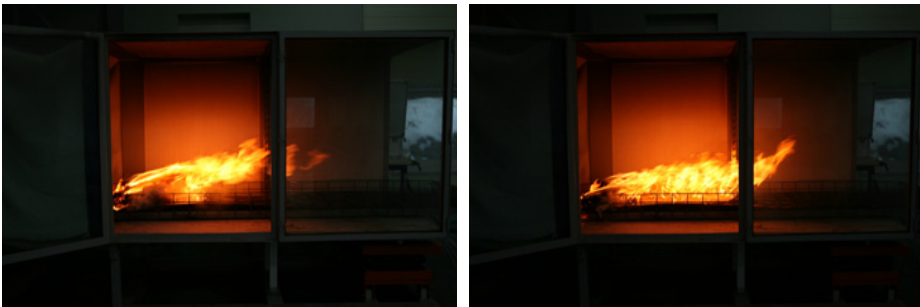
그림 2. 지표화 화염 방화선 구축 연소실험 장면(풍속조건 : 3m/s)
