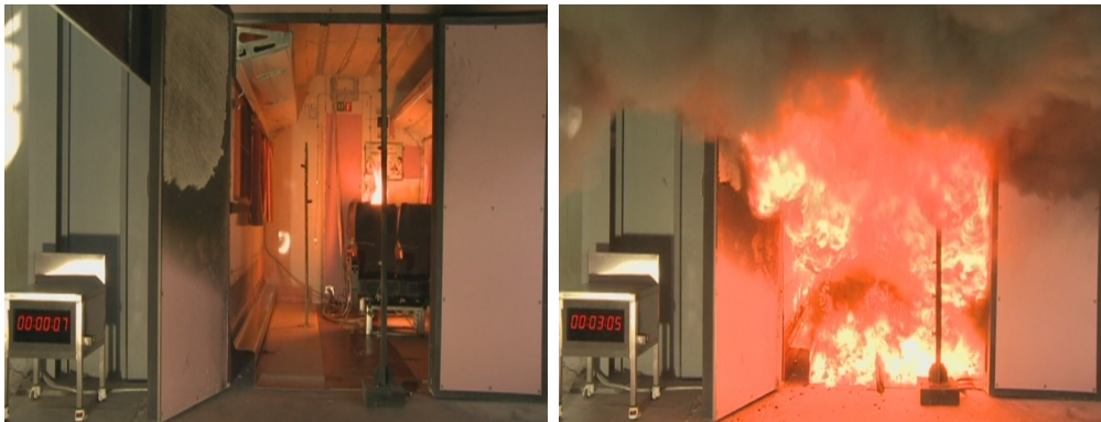
그림 2 룸코너 설비를 이용한 새마을 내장재 조립체의 화재실험
