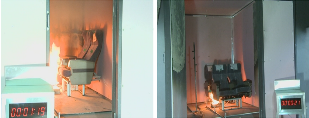
그림 1 룸코너 설비를 이용한 새마을 의자의 화재실험 장면
