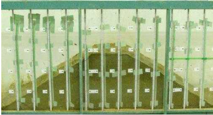
그림 2. 완성된 제방모형의 형상(Case-1)
