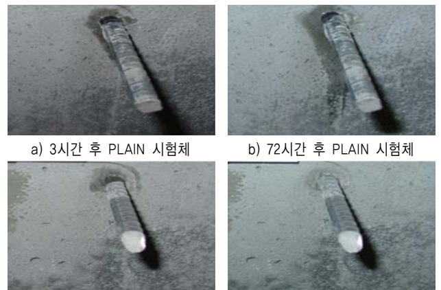
사진 3. 수조 시험체의 철근 부위 누수 관찰
