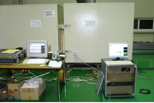
Fig. 3. 미니캠버 차음성능 측정시스템
