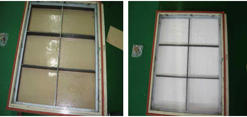
(a)제진재 처리 후 (b)흡음재 부착 후 Fig. 4. 차음구조 시편
