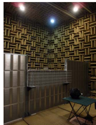
Fig. 2 간섭형 방음장치 무향실 성능시험 장면
