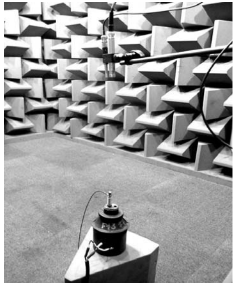
Fig 8. 엔진 마운트 단품 소음 측정 시험 환경
