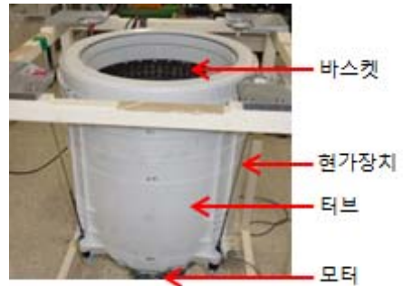
Figure 1 실험용 세탁기 시스템
