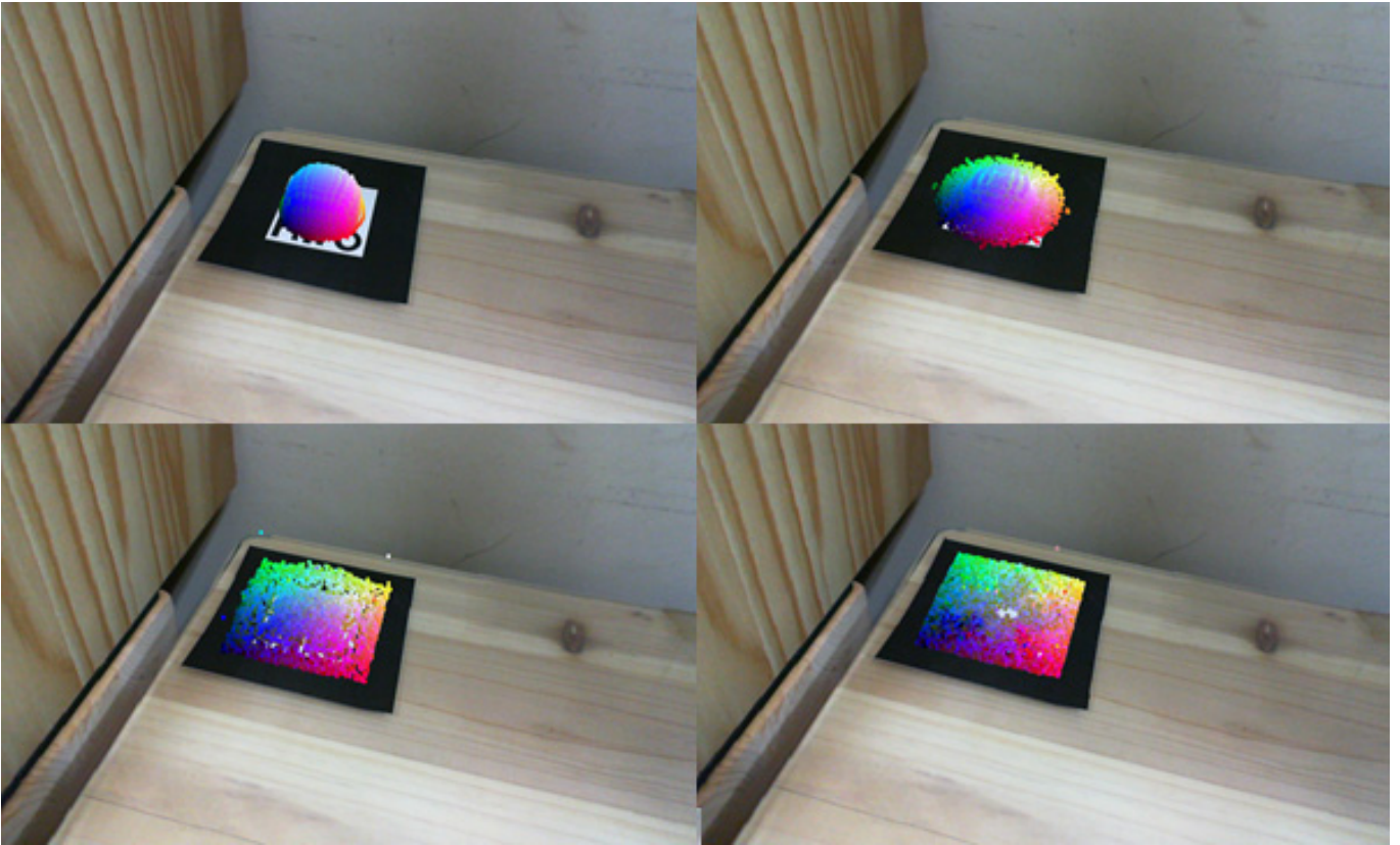
(그림 4) 증강현실을 이용한 정해진 공간에 유체를 떨어뜨렸을 때의 유체 시뮬레이션
