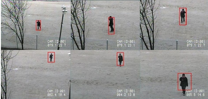
[그림 4] PTZ 카메라에서 검출된 객체의 추적 과정
