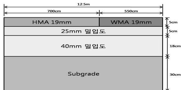
그림 3. WMA 및 HMA 표층시공
