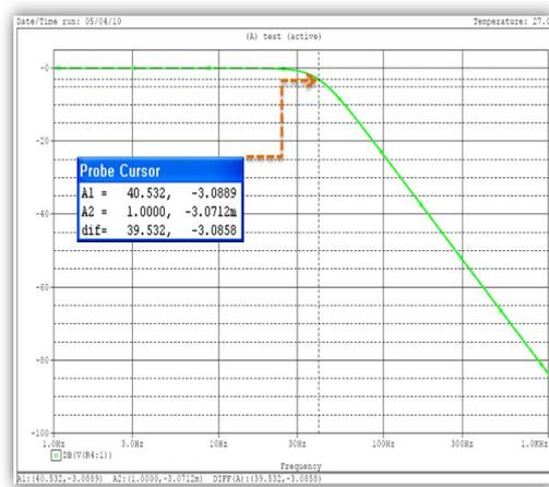
그림 1 PSpice을 이용한 필터 시뮬레이션 결과
