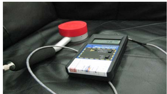
그림 1 표면 오염감시기 (검출기형식 : GM, Inspector/R, 제조사 : S.E. International)
