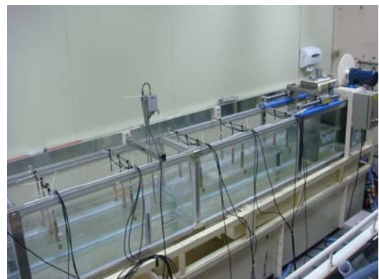
Fig. 1. Layout of the hydraulic prototype instrument 파고계는 조파수조 또는 파랑실험에 있어서 파도의
