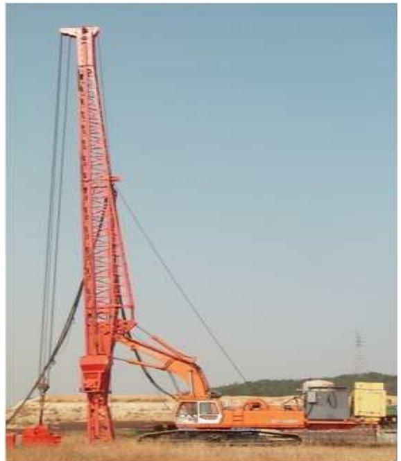
[그림 4] 개발된 포크레인을 이용한 샌드 드레인 장비
