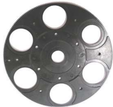
[그림 6] 제작된 자동굴절검사기용 기어(#3,#4)
