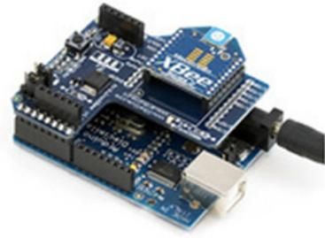
[그림 2] Arduino + Xbee의 PHY 및 MAC 표준을 바탕으로 상위 프로토콜(Protocol)과 응용을 규격화한 기술이며 전송 거리는 10~75m, 배터리는 최소 100일, 최대 1000일 이상의 수명을 유지할 수 있다. 본 프로젝트에서는 아두이노에 아두이노용 Xbee 모듈을 장착하여 센서 노드로서의 역할을 수행할 수 있도록 하였다.
