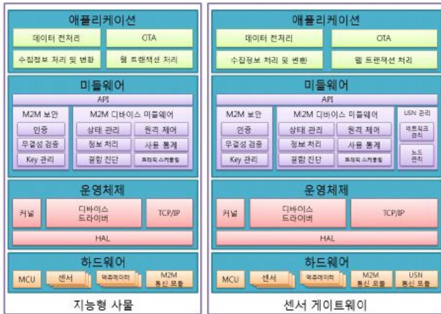
(그림 1) 지능형 사물과 센서 게이트웨이의 플랫폼 구조도[5]
