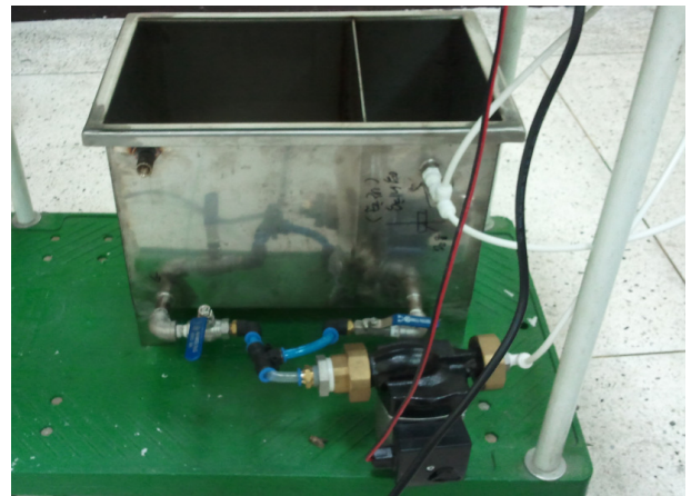
(그림 4) 물탱크와 펌프
