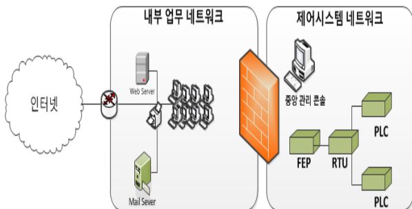
(그림 1) 전형적인 제어시스템 네트워크 구성도[2]
