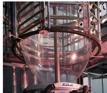
(그림 1) 공압출 다층필름 제조 시스템
