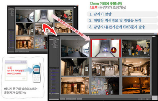
그림 2 영상화재 감지경보 제어 시스템 개념도
