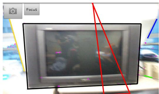
(그림 6) OpenCV를 이용한 사물의 외곽선 인식
