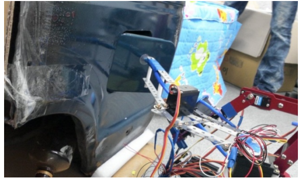
(그림 4) 첫 번째 로봇 팔이 주유 덮개를 여는 모습
