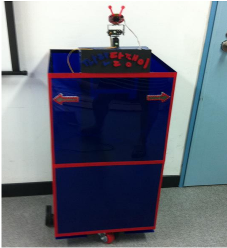
(그림 5) 제안하는 영상기반 사용자 추적 로봇의 앞모습
