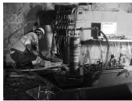
(b) 콘크리트 및 시공이음부 투과특성 실험 모습 (c) 콘크리트 및 주변 암반 투과특성 실험 모습
