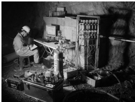
(b) 콘크리트 및 시공이음부 투과특성 실험 모습 (c) 콘크리트 및 주변 암반 투과특성 실험 모습
