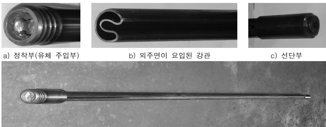
그림 3. 강관팽창형 마찰식 록볼트(SI Bolt)의 구성
