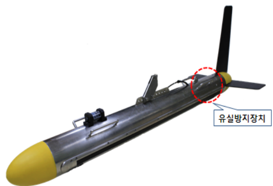
Fig. 2 유실방지장치가 장착된 토우피쉬
