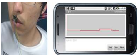
그림 2. 피검자의 수면 중 호흡에 따른 실시간 온도센서 모니터링.
