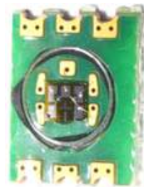
그림 4. MEMS 가공으로 제작한 센서 모듈
