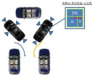
그림 2. 운행 상태 연동형 전방 및 좌우측방 멀티뷰 디스플레이
