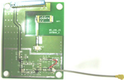
그림 5. 제작된 2.4GHz 및 GPS 안테나 통합 보드
