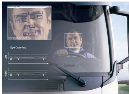
그림 3. 지멘스에서 개발한 트럭용 카메라기반 운전자 졸음 장치 개념도
