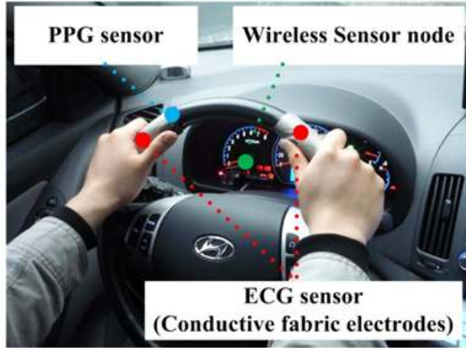
그림 5. 운전대에 부착된 전도성 섬유 전극쌍을 이용한 ECG 측정장치
