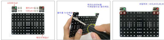
LED보드가 조립될 메인프레임의 위치를 확인합니다. LED보드를 메인프레임의 조립위치에 놓고 볼트를 끼운 다음 손으로 누르고, 육각드라이버를 나트면 다음 육각드라이버를 시계방향으로 돌립니다.
