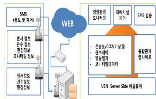
[그림 2] 그린 성장환경 모니터링 시스템 개념도
