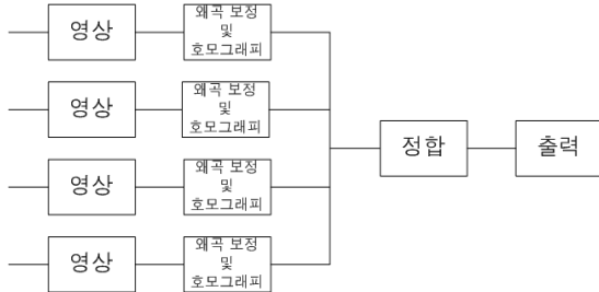
그림 5 Car PC 기반 AVM 시스템의 처리 절차
