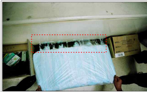
<그림 13> 송풍구의 기저귀 용착 상태
