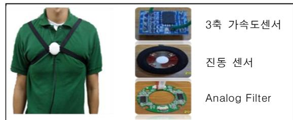
그림 2. 에너지 소모량 측정 센서 및 착용
