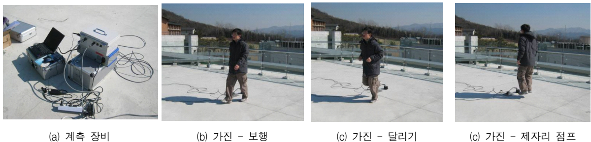
그림 4 바닥 가속도 계측/가진 사진
